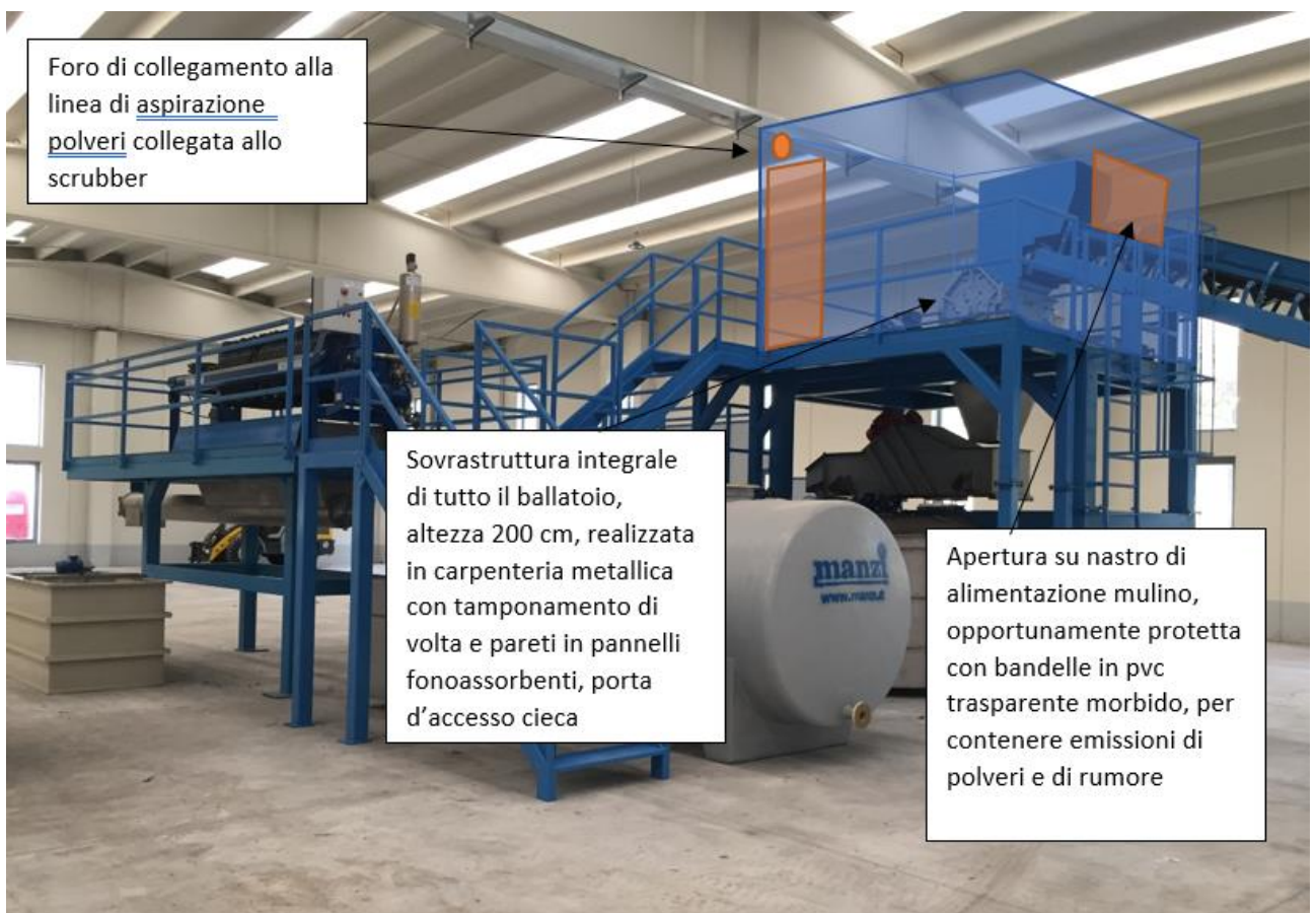
Immagine 10bis – schematizzazione dei sistemi di chiusura filtropressa e mulino
